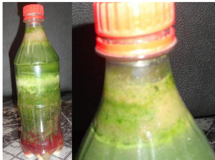
Figura 7. Aspecto da coluna após 8 semanas. No topo podemos visualizar biofilme, com aspecto de películas na superfície da água, contendo um conjunto de bactérias aeróbicas heterotróficas e produtos secretados por elas, principalmente polissacarídeos.
