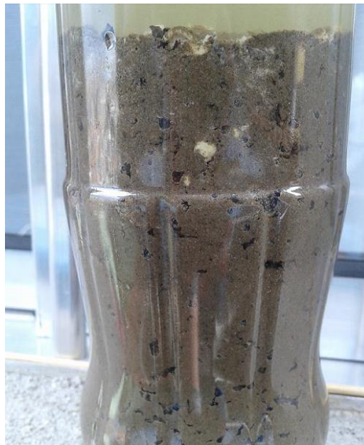
Figura 5. Coluna na primeira semana após a montagem. Podemos visualizar bolhas em meio ao sedimento devidas à produção de H_2S pelas bactérias redutoras de enxofre. Fonte: https://ead2.sead.ufscar.br/course/view.php?id=989&section=1
