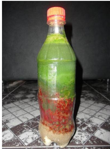
Figura 6. Coluna na quarta semana após a montagem. Na região central, as zonas avermelhadas e esverdeadas se devem ao desenvolvimento das bactérias verdes e púrpuras sulfurosas. Na região superior, a multiplicação de algas deixou a água com uma coloração esverdeada.
